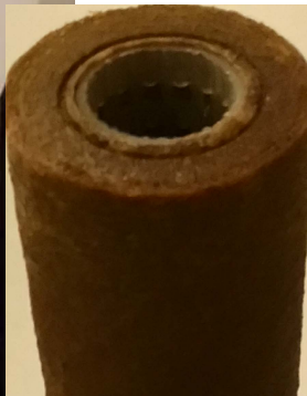
Filterpatroner med avlagringar och skillnaden mot en ny filterpatron för varmvattencirkulationen
