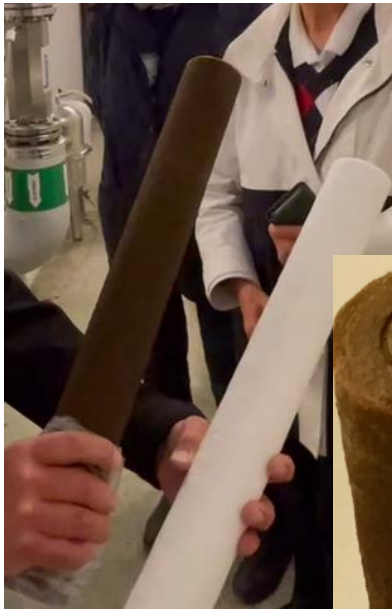
Filterpatroner med avlagringar och skillnaden mot en ny filterpatron för varmvattencirkulationen
